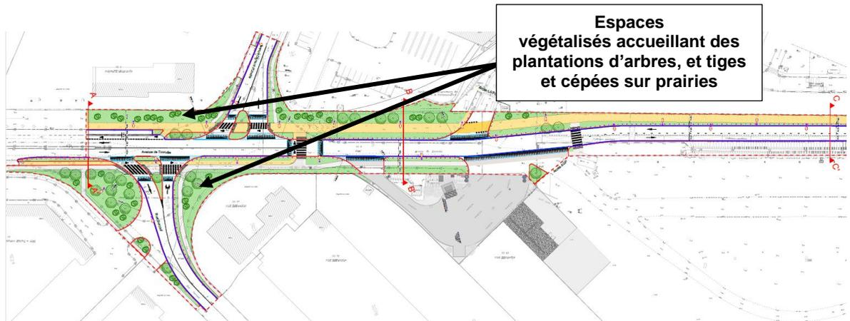
**Fig. 7. Requalification de la voirie et création voie verte : schéma de principe (source Bordeaux Métropole)**
