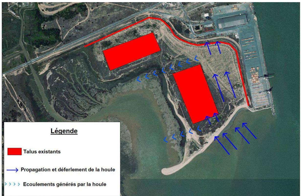
Figure 5-107 : Principe de propagation de la houle et des clapots dans l'état actuel
