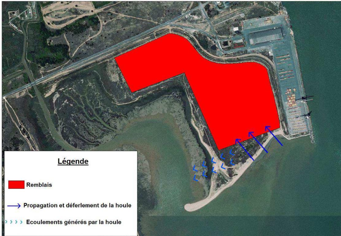
Figure 5-108 : Principe de propagation de la houle et des clapots dans l'état aménagé
