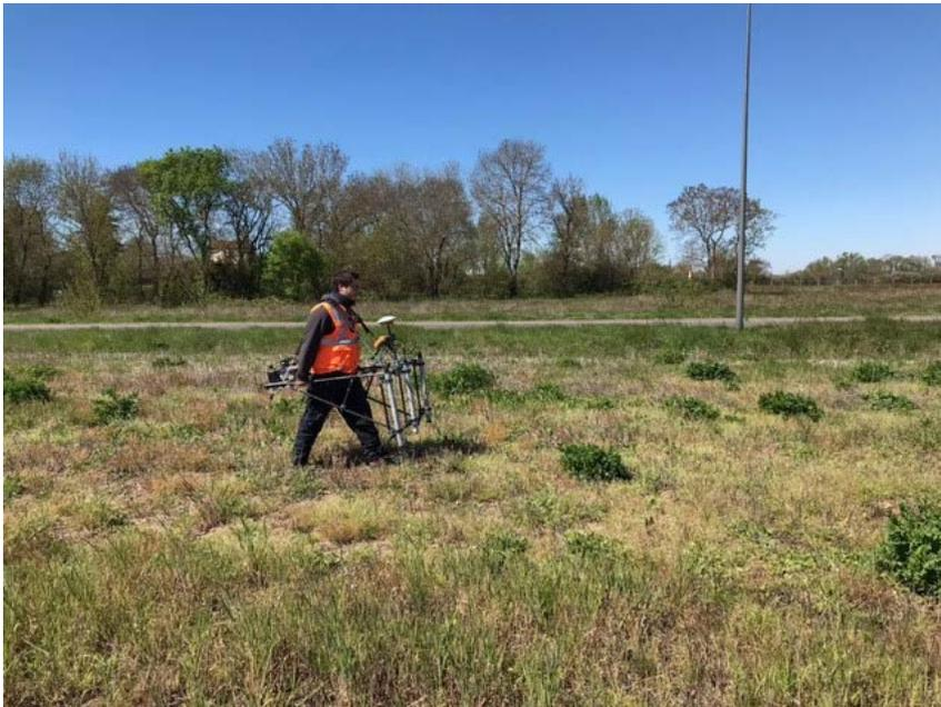
*Figure 11: Dispositif magnétométrique MXPDA 3 sondes*
