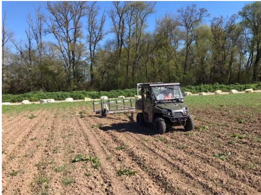
Figure 12 : Dispositif magnétométrique MXPDA 8 sondes
