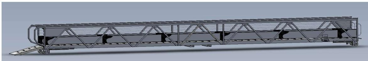
Le terme « **Double-passerelles** » désigne exclusivement les systèmes à double-passerelles, composés de 3 structures - 2 passerelles + un palier intermédiaire - (schéma d'ensemble d'un système à double-passerelles ci-dessous).
